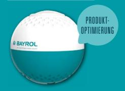
Dosierschwimmer für 200 g / 250 g Chlortabletten (bis zu 4 Tabletten). Mit einstellbarer Dosieröffnung und Leerstandsanzeige: Deckel bewegt sich nach oben wenn der Schwimmer leer ist. Art.-Nr. 411037 EAN Code 4008367110376 VE 6
