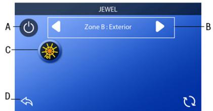
(C) Dimmersteuerung: Das wiederholte Drücken dimmt die Helligkeit der Außenbeleuchtung, bis sie ausgeschaltet ist. Das erneute Drücken wird den Zyklus mit der größten Helligkeit erneut starten.
